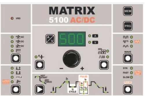
Данный аппарат заменил аппарат предыдущего поколения **CEA MATRIX 500 AC/DC**, снятый с производства, а также является более мощной версией аппарата **CEA MATRIX 5000 AC/DC** с увеличенным ПВ% (60% вместо 35% при 40°C)
