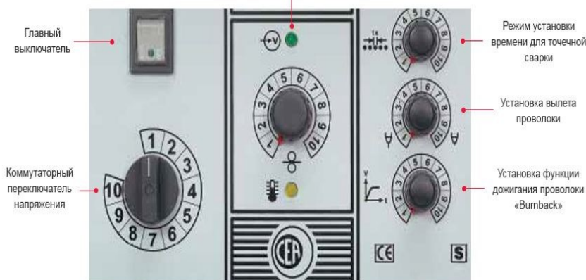
Установка скорости подачи проволоки и индикаторы напряжения и перегрева
